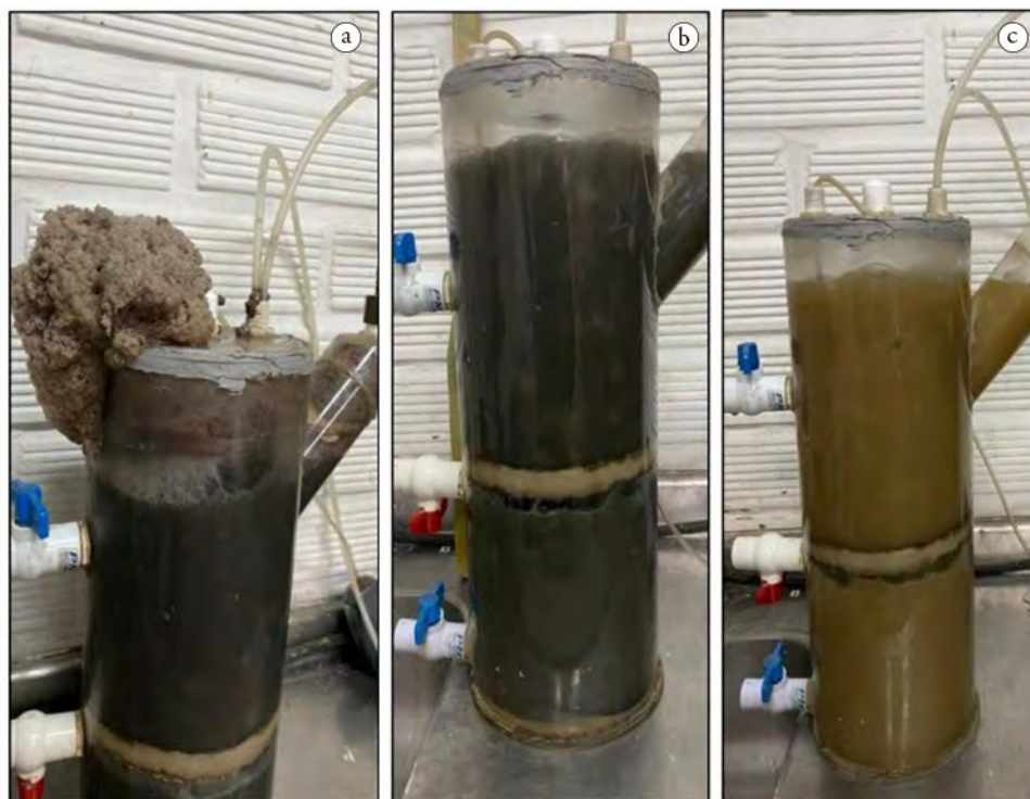
Figura 1. Reactor donde se realizó el proceso oxidativo del percolado y las diferentes etapas del proceso de estabilización. a) Percolado al inicio del proceso; b) Percolado después de 1 día de tratamiento; c) Percolado después de 15 días de tratamiento.
