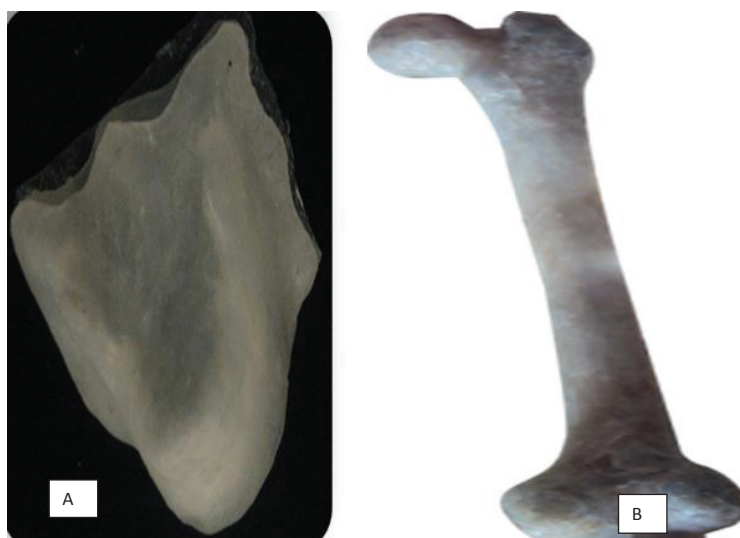
Figura 1. Molde primario. A) Hueso mandíbula y B) Hueso fémur, cubiertos con caucho de silicona.
