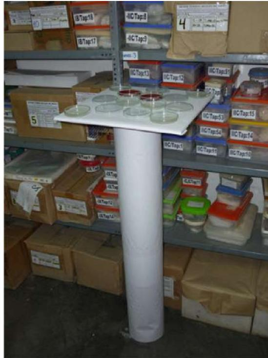
Figura 2. Muestreo de aire en almacén.
