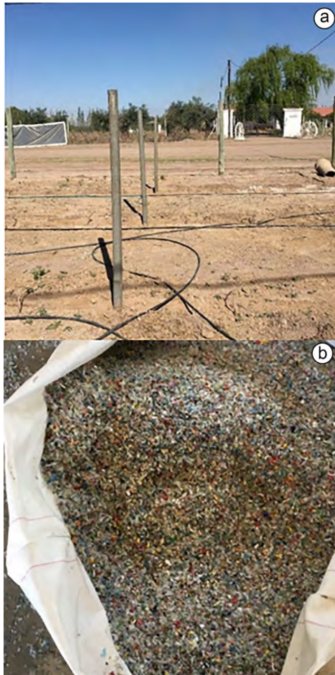
Figura 1. a) Poste de plástico para la venta; b) residuo plástico molido que ingresa a la extrusora.
